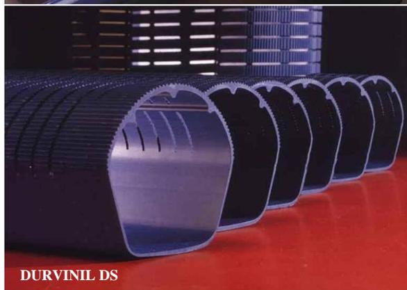
Трубы **DURVINIL DS** предназначены для дренажа воды из почвы инфраструктурных сооружений (насыпи железной дороги, базовые слои автомобильных дорог) или как часть туннельных дренажных систем. Это поддерживается формой (подкова), а также расположением дренажных надрезов, которые расположены только в верхней дугообразной части профиля.
